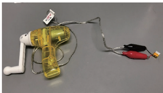
図 2 電池 A と手回し発電機を繋いだ様子
