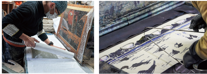
図1 注染の工程（手拭いの例） 伊勢保染工所にて撮影
